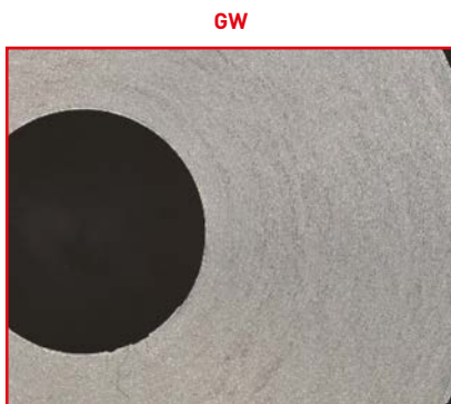
Angolo di inclinazione 8° – Rz 7.9 µm
