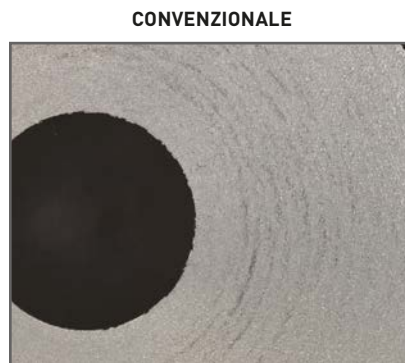
Angolo di inclinazione 6° – Rz 11.3 µm
