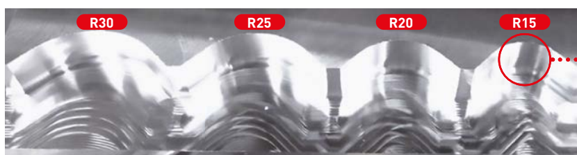
Vc = 200 m/min, R15, Foto scattata dopo la lavorazione
