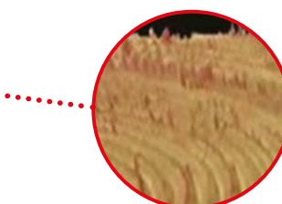
La rugosità può verificarsi nell'area a bassa velocità di taglio (vicino al centro)
