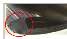
Danneggiamento dovuto a mancanza di robustezza
